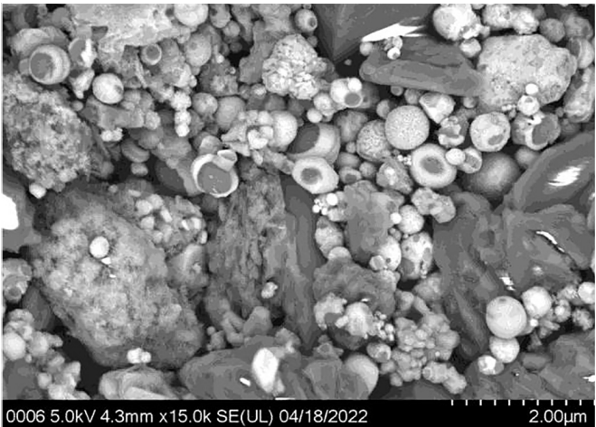
Рис. 3. Электронная микрофотография частиц аэрозоля, образующихся при плавке черного свинца (чем светлее объект, тем больше атомная масса химических элементов, из которых он состоит).
